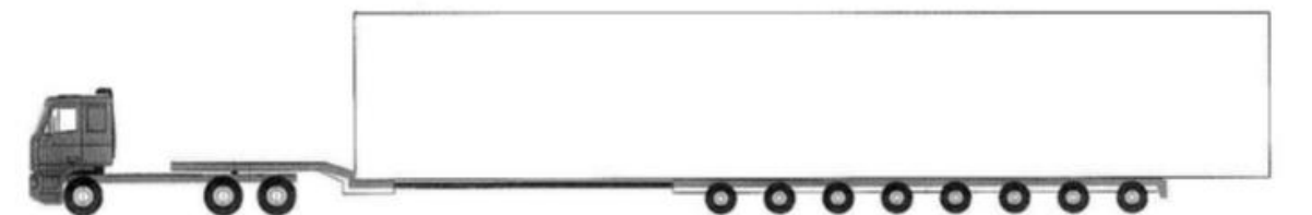
Transport d'une section d'un mât
