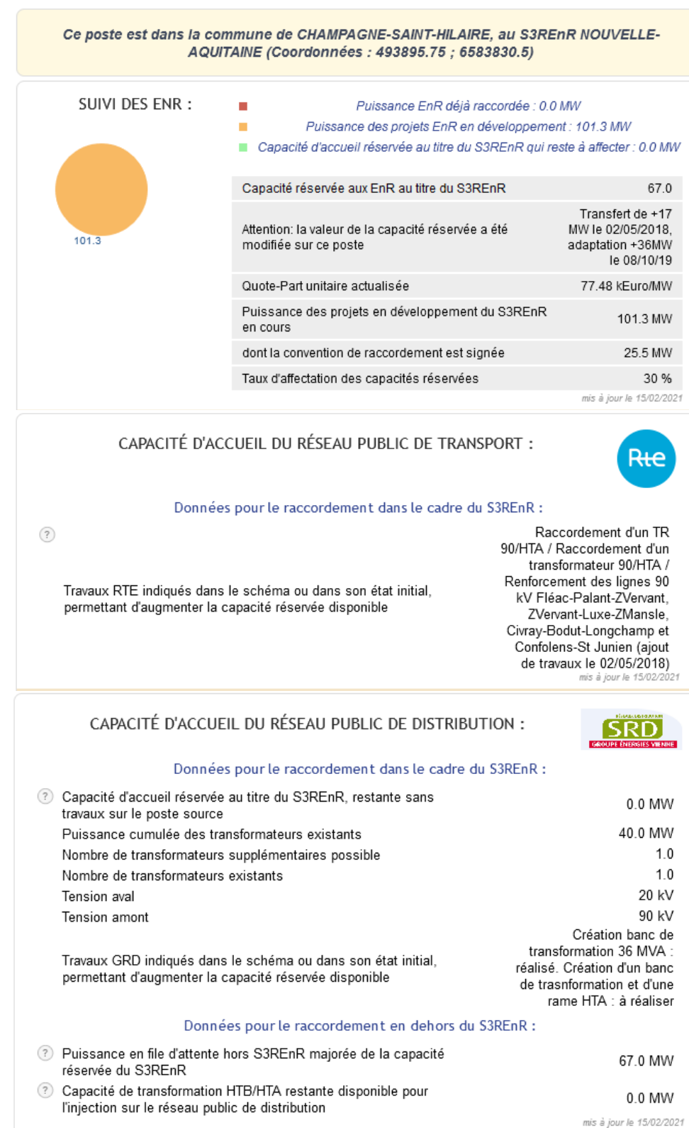
Figure 29 : Caractéristiques du poste source de Champagné-Saint-Hilaire
